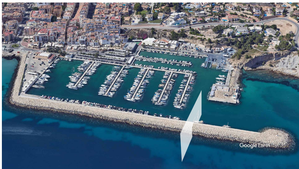
Figura 18. Imagen aérea de Google Earth del puerto de Moraira en la que se aprecia el manto exterior de escollera. Se indica la sección del dique principal mostrada en la figura 17.
